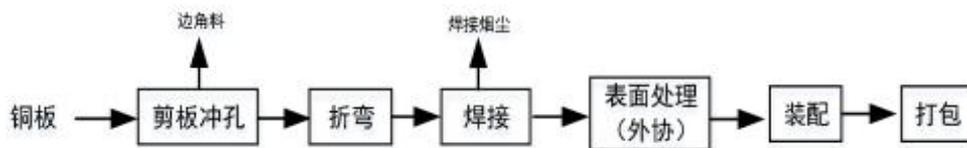
铜门生产工艺流程图
