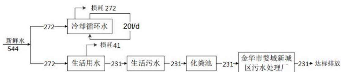
项目水平衡图 t/a
