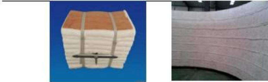
CO 箱体内部采用高铝型硅酸铝纤维保温模块，最大保温厚度 200mm，保温效果优于普铝或高纯型纤维棉。保温按照 GB4272《设备及管道保温设计通则》）的要求进行，在高温部分设警示标志。
